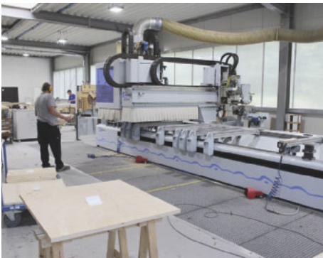
/ Bearbeitungsvielfalt ohne Grenzen: Bereits seit vielen Jahren nutzt Jahn eine Fünf-Achs-CNC von Homag.
