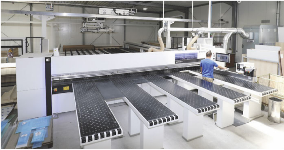
/ Zuschnitt optimiert: Die neue Plattenaufteilsäge von Homag wird direkt aus dem automatischen Plattenlager beschickt.
