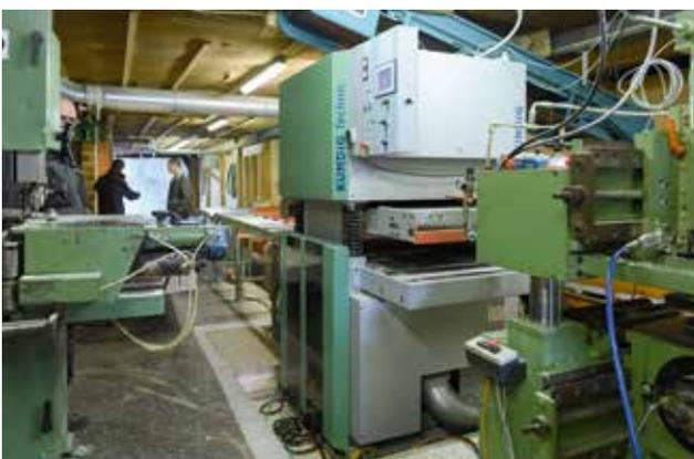
*Aufgrund der beengten Platzverhältnisse in der Linie benötigte Sprenger & Söhne eine sehr kompakte Industrieschleifanlage.*
