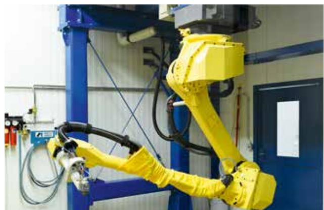
Sogar ein Sechssachs-Lackierroboter mit 3D-Elementerkennung steht bei Remmers zur Verfügung.
