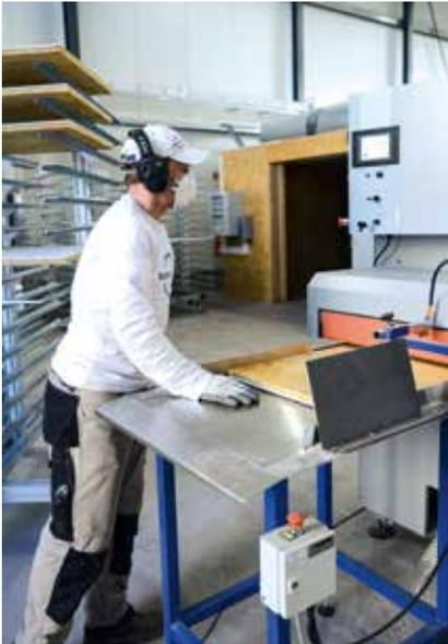
*Der Schutz von Verarbeitern steht an erster Stelle, die Maschine wurde mit einer sehr effizienten Staubabsaugung ausgerüstet.*
