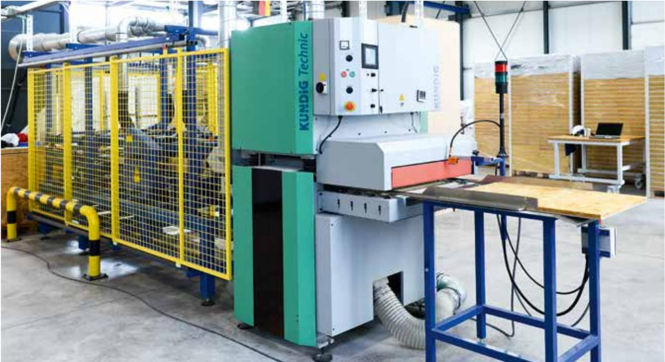
*Wegen der flexiblen Dämmschicht auf der Rückseite wurde die Maschine unten schleifend ausgeführt. Das vereinfachte auch die Plattenmanipulation innerhalb der Linie.*
