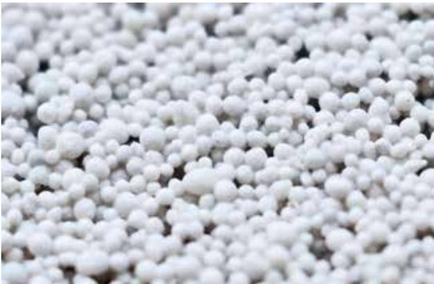
*Die Nahaufnahme zeigt die Oberfläche der Platten aus Blähglasgranulat nach dem Aushärten.*
