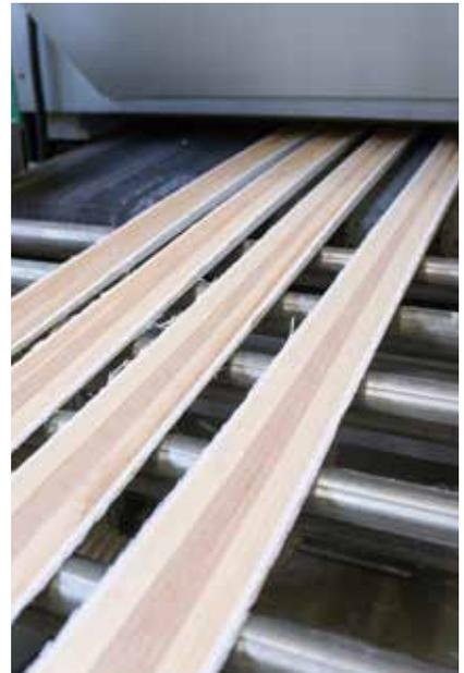
*Durch CNC-Schleifen kann eine Rennskigeometrie haargenau reproduziert werden.*
