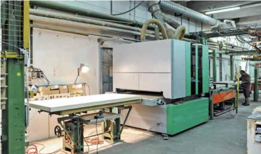
Die Schleifanlage ist in einer automatisierten Fertigungsstrasse integriert.
