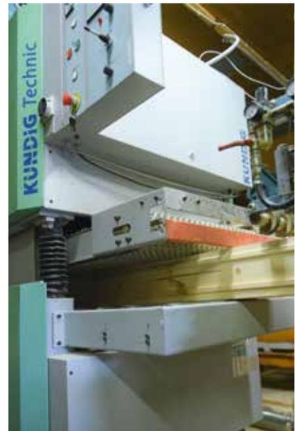
*Die unten schleifenden Aggregate der Kündig Technic Botex-2 könnten mit bis zu einer halben Tonne belastet werden.*
