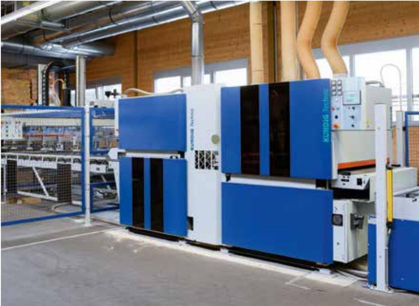
Mit sechs oben- und untschleifenden Aggregaten kann die Anlage in nur einem Arbeitsgang Massivholzplatten mit fertiger Oberfläche herstellen.
