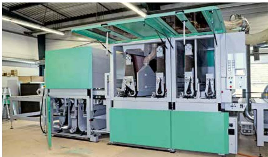
Mit Hobelaggregaten, Kalibrierwalzen und Elektronikschuh-Schleifaggregaten schafft die Kündig Technic Botop-7 alle Arbeitsprozesse nun in einem einzigen Durchgang.
