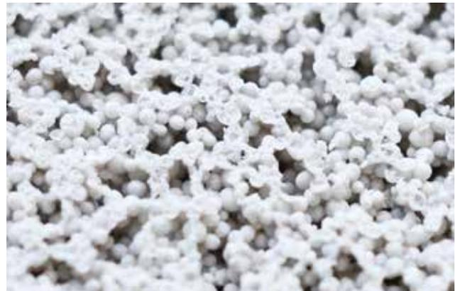
*Beim Schleifvorgang werden die Glaskugeln präzise aufgeschliffen, was die akustisch wirksame Oberfläche vergrößern soll.*
