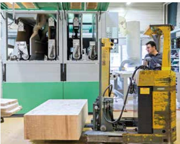
*Der 440 kg-Block wird zum Probeschleifen in die Anlage eingeheben, deren Ausmaße man hier ein wenig erahnen kann.*
