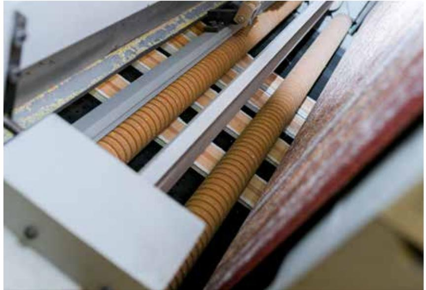
*Das Schleifaggregat kann sich während des Schleifens CNC-gesteuert auf- und ab bewegen und bis zu 16mm auf einmal zerspanen.*
