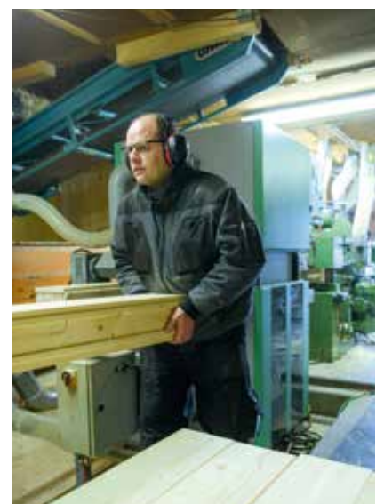
Die unten schleifenden Aggregate der Kündig Technic Botex-2 könnten mit bis zu einer halben Tonne belastet werden.
