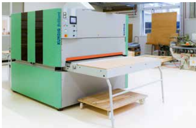
Trotz üppiger 1600 mm Arbeitsbreite ist die Anlage insgesamt kompakt. Sie ermöglicht glattere Oberflächen bei Fenstern.
