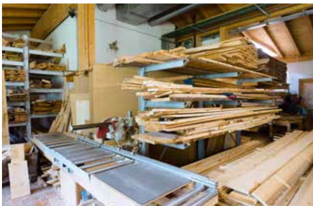
Überall im Betrieb lagert das kostbare Rohmaterial. Durch die Konditionierung „steht“ es dann besser.
