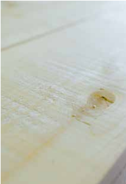
Vorher – Nachher: Hobelschläge und Ausrisse werden mit der Schleifanlage egalisiert.
