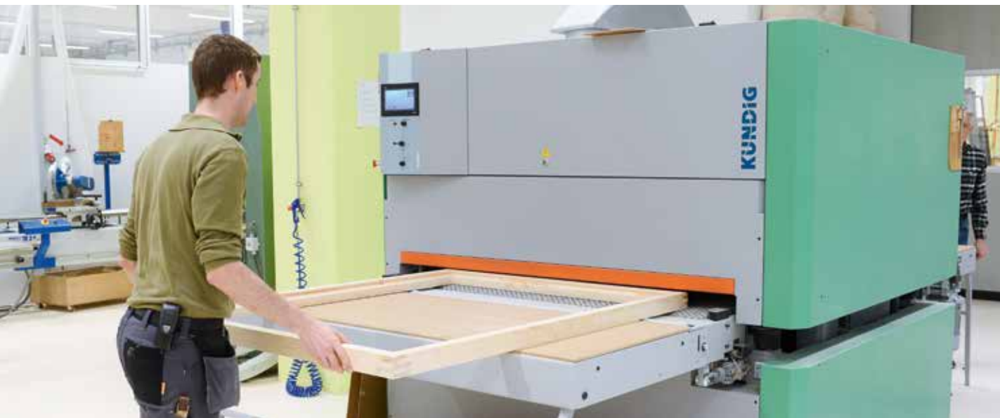
Fensterrahmen und -flügel können bei der Kündig Brilliant-2 1600-RdPd-F mit ihrer serienmäßigen Arbeitsbreite von bis zu 1600 mm gerade eingelassen werden. Ein spezielles Schleifverfahren sorgt für perfekte Oberflächen.
