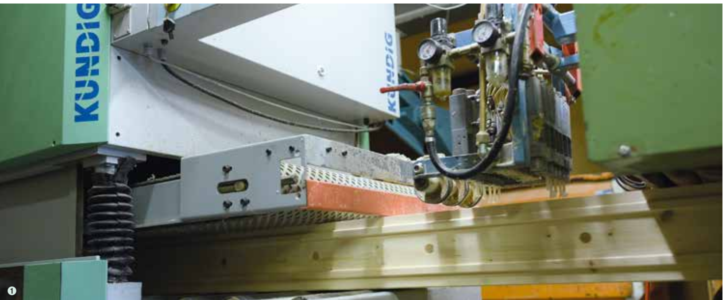
❶ Für makellose Sichtflächen schleift das Schweizer Holzbauunternehmen Sprenger & Söhne seine Brettstapelbalken nach dem Hobeln zusätzlich. Die unten schleifende Kündig Technic Botex-2 650-RP könnte dabei noch deutlich schwerere Elemente „schlucken“... ❷ Edwin Sprenger ist ein Vorreiter in Sachen Oberfläche: „Die Auffassung, was eine Sichtqualität ist, hat sich deutlich verändert.“ ❸ Die Hobelschläge des leistungsfähigen Vierseiters sollten zugunsten einer besseren Oberflächenoptik verschwinden. ❹ Holzbaupolier Hans Brunner (li.) ist mit der Leistung zufrieden: „Der Vorschub unserer Kündig hat noch nie blockiert.“
