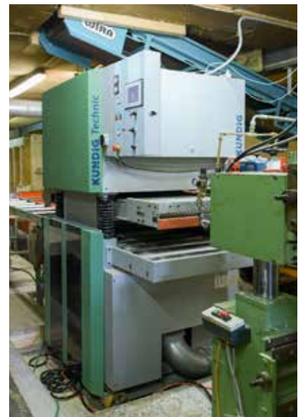
Die unten schleifenden Aggregate der Kündig Technic Botex-2 könnten mit bis zu einer halben Tonne belastet werden.
