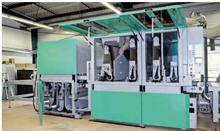
Mit Hobelaggregaten, Kalibrierwalzen und Elektronikschuh-Schleifaggregaten schafft die Kündig Technic Botop-7 alle Arbeitsprozesse nun in einem einzigen Durchgang.
