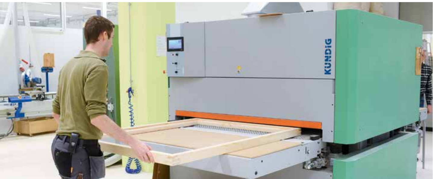
Fensterrahmen und -flügel können bei der Kündig Brilliant-2 1600-RdPd-F mit ihrer serienmäßigen Arbeitsbreite von bis zu 1600 mm gerade eingelassen werden. Ein spezielles Schleifverfahren sorgt für perfekte Oberflächen.
