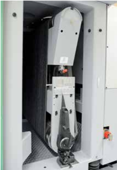
Das Schleifaggregat bewegt sich in der Vertikalachse.
