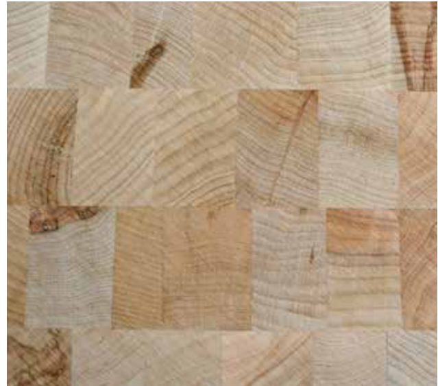
Vorher – Nachher: Verleimbedingter Höhenversatz wird mit den beiden Hobelaggregaten egalisiert. Kalibrierwalzen und Diagonalschleifaggregate sorgen dann für eine perfekte Oberflächengüte auch bei Hirnholz.
