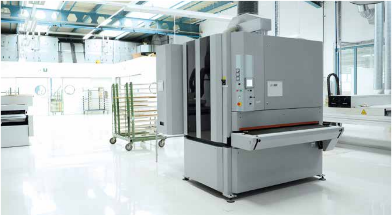
Die Kündig Brilliant CdHL bietet üppige 1600 mm Arbeitsbreite und ist mit Diagonal- und Querbandaggregat ausgerüstet.
