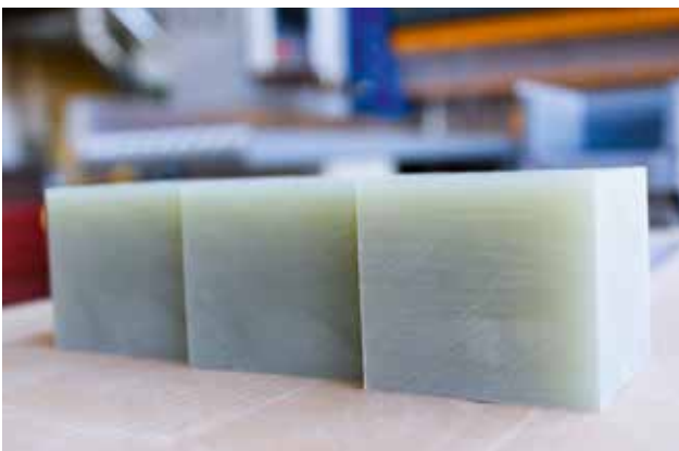
Ausgangsmaterial sind faserverstärkte Kunststoffe die sich besonders exakt bearbeiten lassen.
