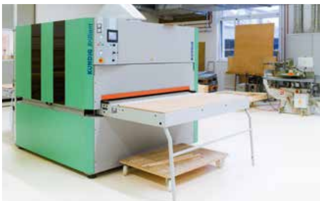
Trotz üppiger 1600 mm Arbeitsbreite ist die Anlage insgesamt kompakt. Sie ermöglicht glattere Oberflächen bei Fenstern.
