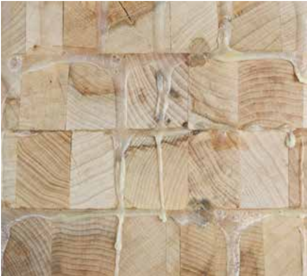
Vorher – Nachher: Verleimbedingter Höhenversatz wird mit den beiden Hobelaggregaten egalisiert. Kalibrierwalzen und Diagonalschleifaggregate sorgen dann für eine perfekte Oberflächengüte auch bei Hirnholz.
