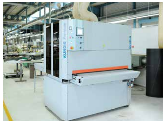
Die zweite Maschine, eine Zweiband Kündig Premium, wird für schwere Kalibrierschleifarbeiten eingesetzt.
