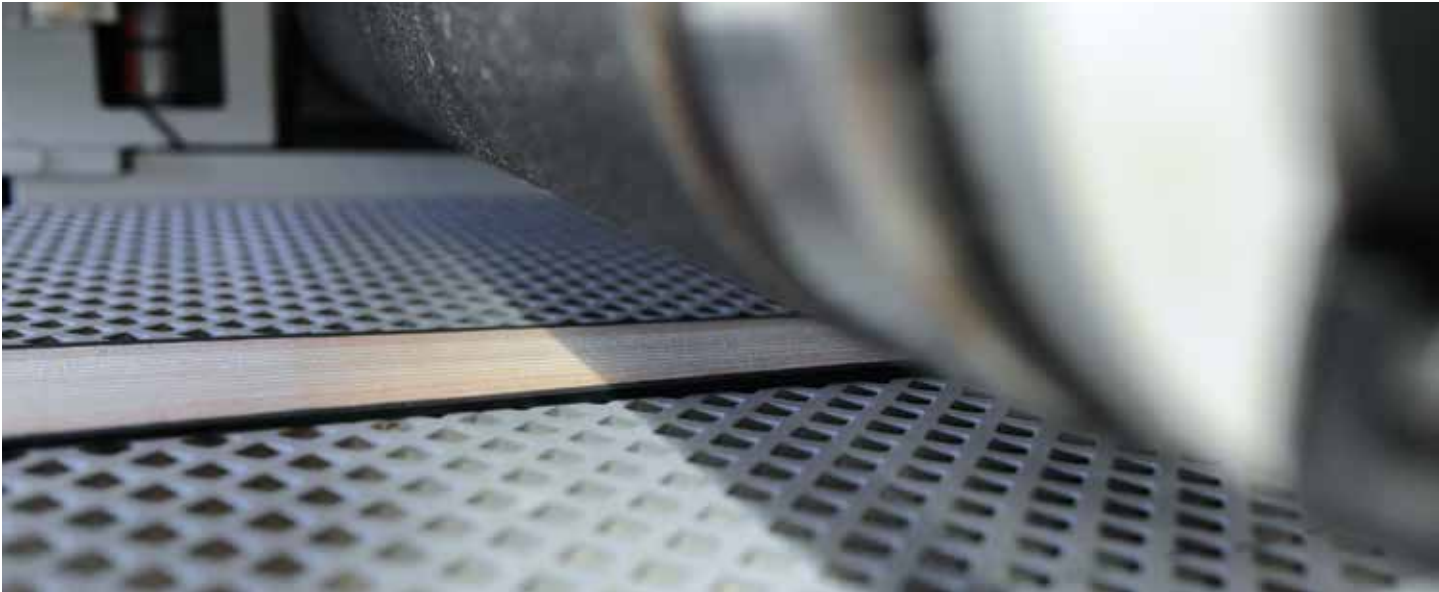
Die CNC-Schleiftechnologie ermöglichte der Skiindustrie die Verwendung neuer Kernmaterialien. Heute werden mit den Anlagen von Kündig neben Holz auch Kohlefaser-, Polyurethanschaum- und Honeycombkerne geformt.
