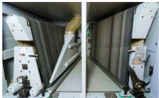
Die V-förmig stehenden Aggregate erlauben es, Rahmen gerade einzulassen und die gesamte Maschinenbreite auszunutzen.
