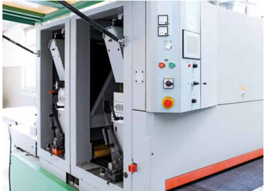
Zwei Präzisions-Schleifaggregate ermöglichen eine besonders exakte Einhaltung der Dicke über die gesamte Arbeitsbreite.
