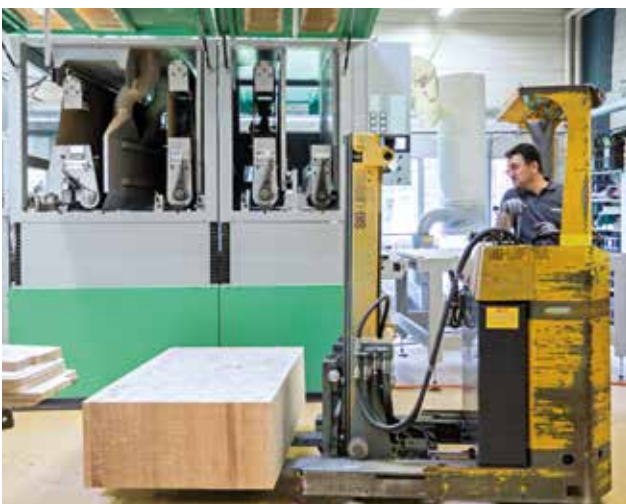
Der 440 kg-Block wird zum Probeschleifen in die Anlage eingehoben, deren Ausmaße man hier ein wenig erahnen kann.
