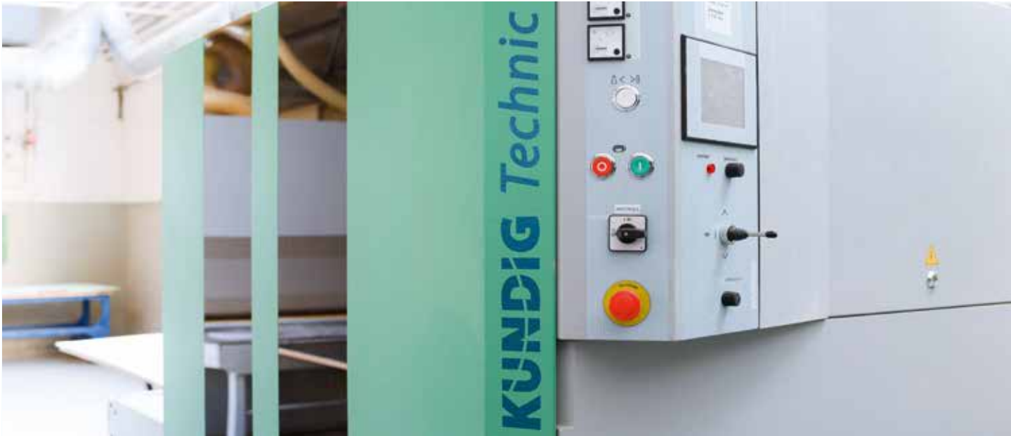
Mit dieser Kündig Technic Precision-2 1350-RRz konnte Von Roll Composites neue Kunden in einem umkämpften Markt gewinnen. Mit der hochpräzisen Schleifanlage werden Compositplatten auf Toleranzen unter \pm 0,03 mm geschliffen.
