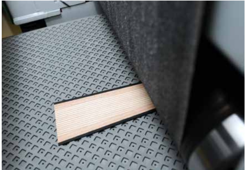
Durch eine Vakuumaufspannung werden die Teile bei Zerspanungsleistungen von bis zu 16 mm sicher geführt.
