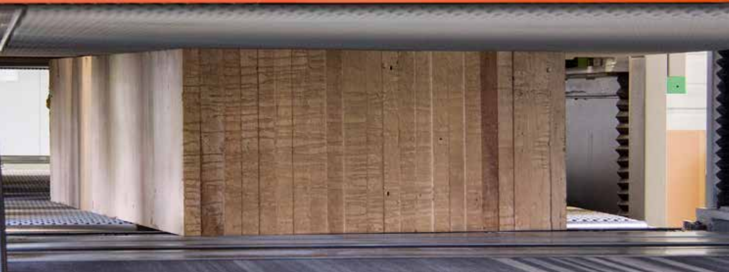
Eine halbe Tonne Holz: Mit sieben Hobel- und Schleifaggregaten wird die Kündig Technic auch mit diesem «Monsterblock» fertig.
