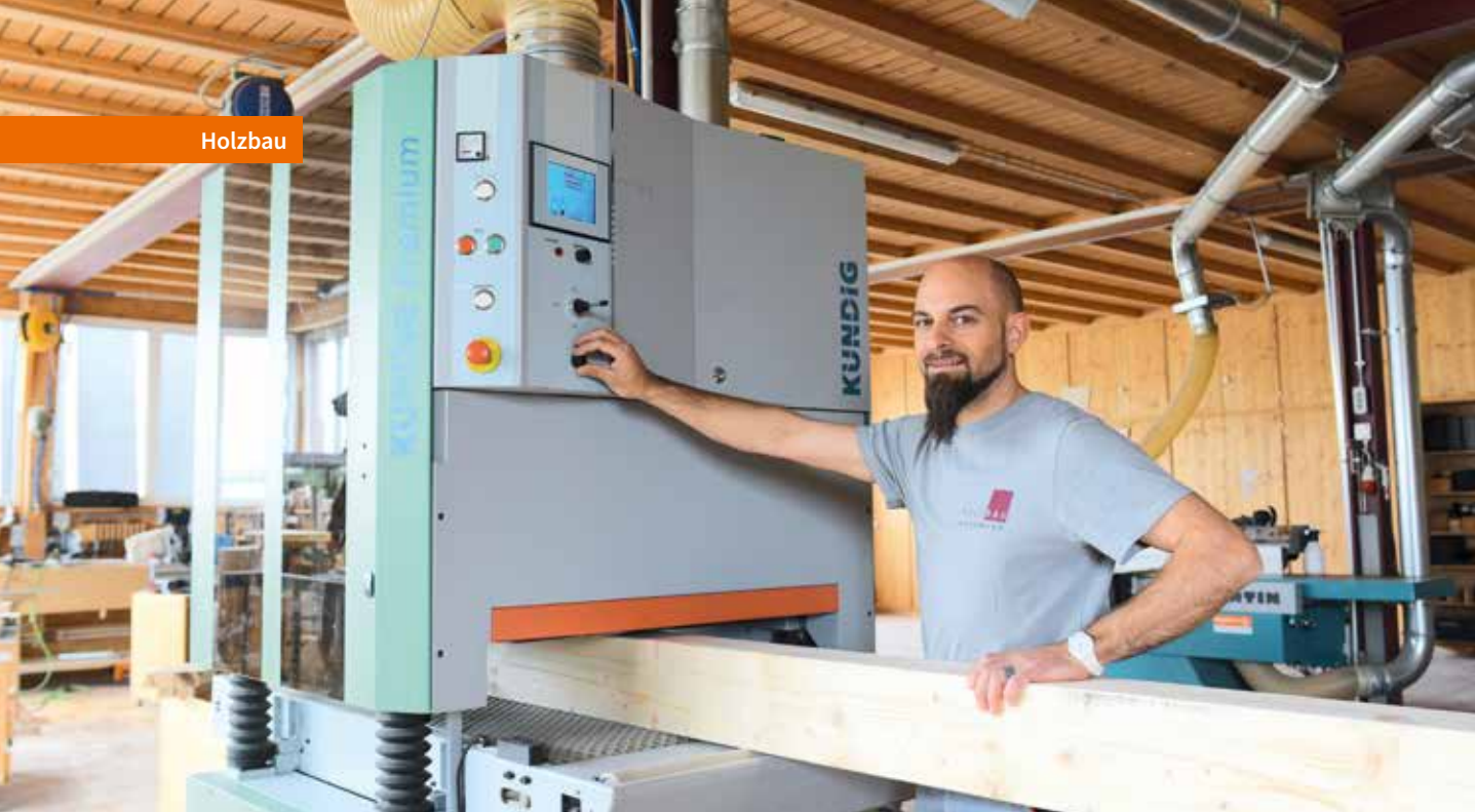
Was andernorts gerade modern wird, ist bei Holzbau Moosmann seit Jahrzehnten gelebte Praxis: Das Schleifen sichtbarer Konstruktionsvollhölzer. Die Kündig Premium-2 650-RP eignet sich dafür ausgezeichnet, heißt es.
