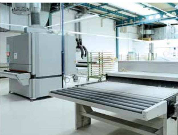
Die geringe Staubentwicklung ermöglicht den Betrieb direkt neben der UV-Lackieranlage.
