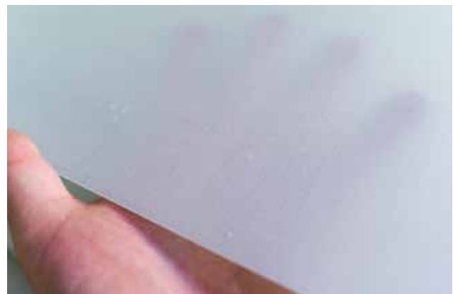
Die dünnsten Platten sind nur 0,3 mm dick, was sogar den an sich undurchsichtigen Kunststoff durchscheinend werden lässt.
